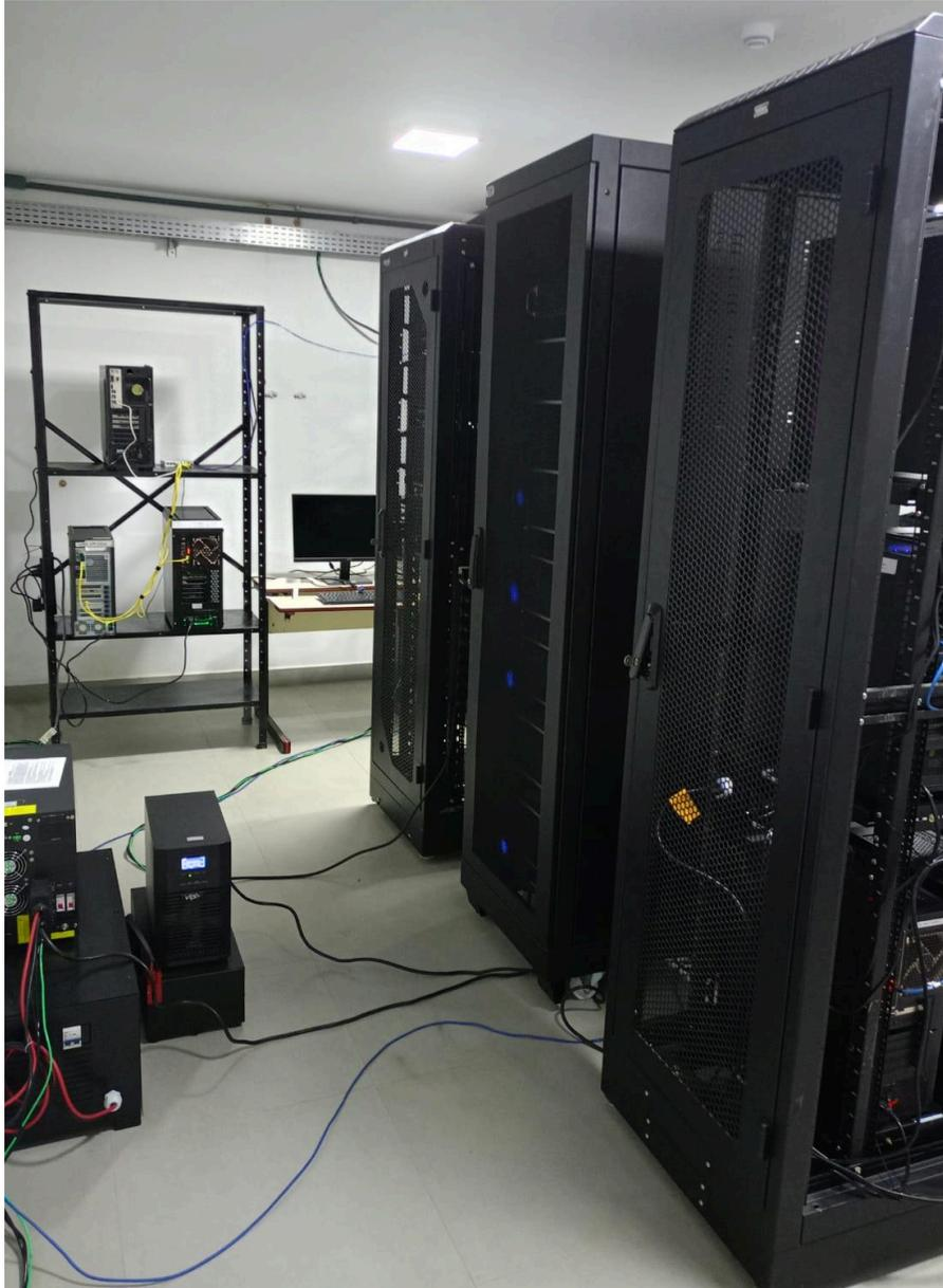
O sci-com conta com um head node (`scicom`) e 20 compute nodes. Há um storage HDD de 96TB e um scratch local SSD de 1TB em cada nó. O sistema operacional é Rocky Linux e o sistema de gerenciamento de fila é SLURM. A conexão de rede é de 1.0Gbps e há um nobreak de 11KVA e outro de 6KVA.
